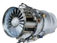
Die PW500-Antriebe sind Zweiwellen-Zweistromtriebwerke, zu deren Modellen PW530 und PW545 die MTU die Entwicklung und Produktion der kompletten Niederdruckturbinen einschließlich Austrittsgehäuse und Mischer beiträgt.
