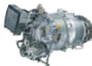
Das PW200 von Pratt & Whitney Canada ist ein Antrieb für leichte und mittlere Hubschrauber. Es zeichnet sich unter anderem durch eine einfache und robuste Auslegung und eine digitale Regelung aus.
