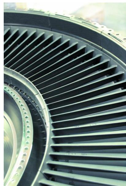
M2: Level-2-Bauteile: Leitschaufeln, verbaut in der Niederdruckturbine des V2500
