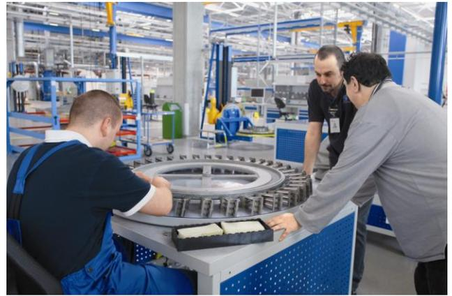
M4: Montage von Triebwerksschaufeln (Quelle: MTU Aero Engines)
