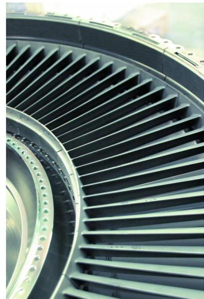
M2: Level-2-Bauteile: Leitschaufeln, verbaut in der Niederdruckturbinen des V2500
