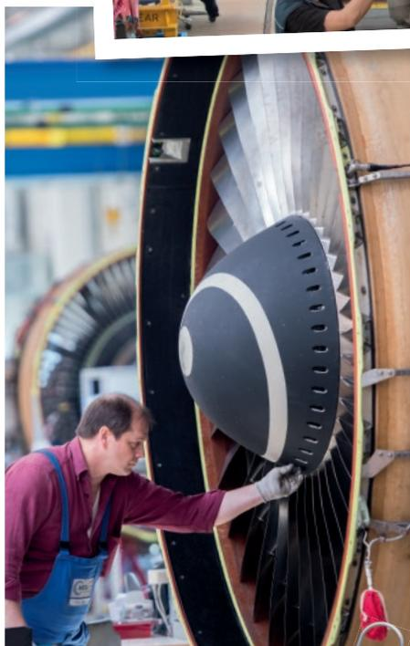
Das CF6 ist ein Zweiwellen-Zweistrom-Triebwerk für Mittel- und Langstrecken-Großraumflugzeuge von Airbus und Boeing.
