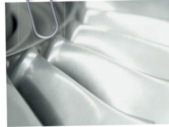
**Blisks** (Blade Integrated Disks) sind Hochtechnologie-Bauteile, bei denen Scheibe und Schaufeln aus einem Stück gefertigt sind bzw. zu einem Teil verbunden werden und nicht mehr zusammengesteckt werden.
