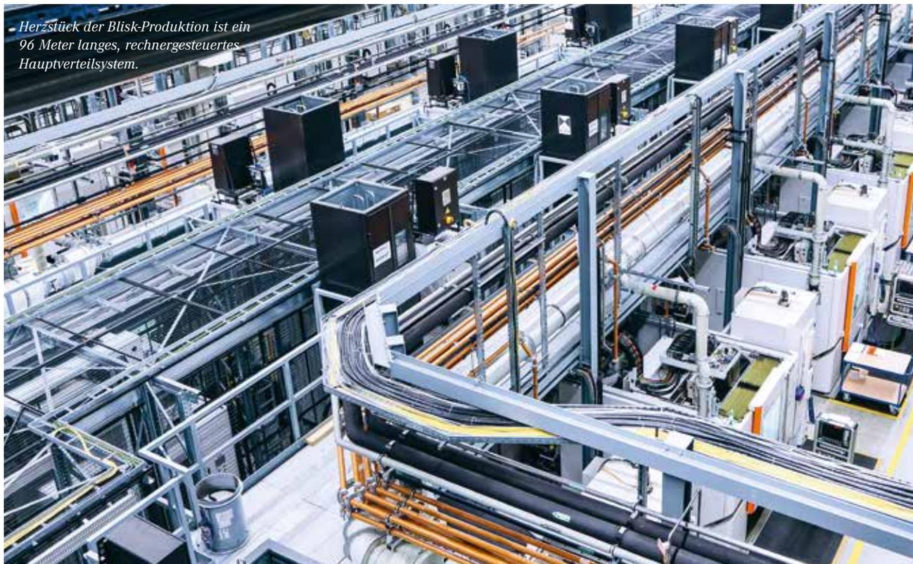
*Herzstück der Blisk-Produktion ist ein 96 Meter langes, rechnergesteuertes Hauptverteilsystem.*
